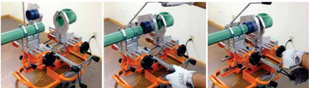
Slika br. 38: Postupak insertacije cevi i fittinga na teflonske glave
