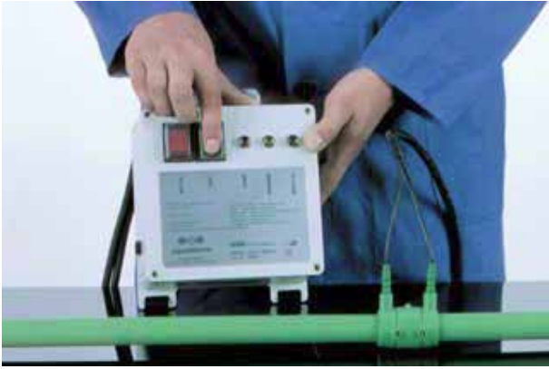
Slika br. 34: Prikaz uključivanja EF aparata, priključenog na EF spojnicu na pravilan način
