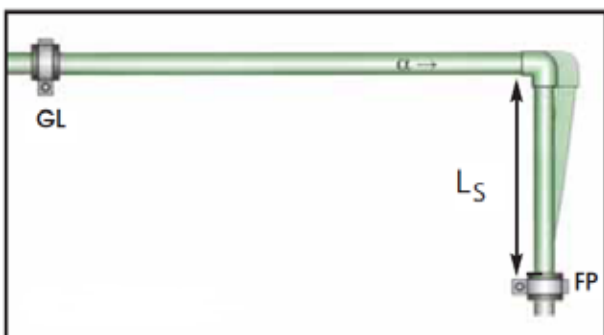
Slika br. 60: Prikaz pravilnog prihvatanja podužnih dilatacija putem promene pravca, gde su GL- klizni ležaj (oslonac), a FP fiksni ležaj (fiksni oslonac), dok je L_s - potrebna dužina promene pravca.
