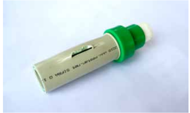
Slika br. 65: Primer pucanja PP-R-FG cevi
