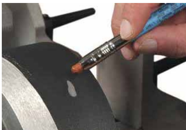
Slika br. 22: Kontrola temperature grejača putem termičke olovke
