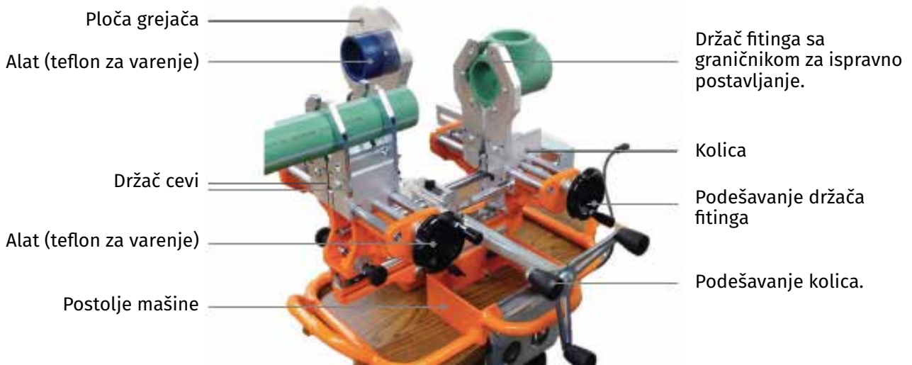
Slika br. 35: Izgled stacionarne mašine za zavarivanje
