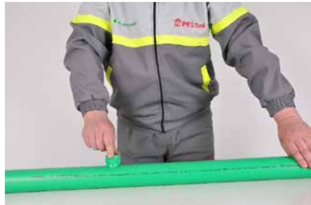
Slika br. 29: Insertacija sedlaste spojnice na zid cevi
