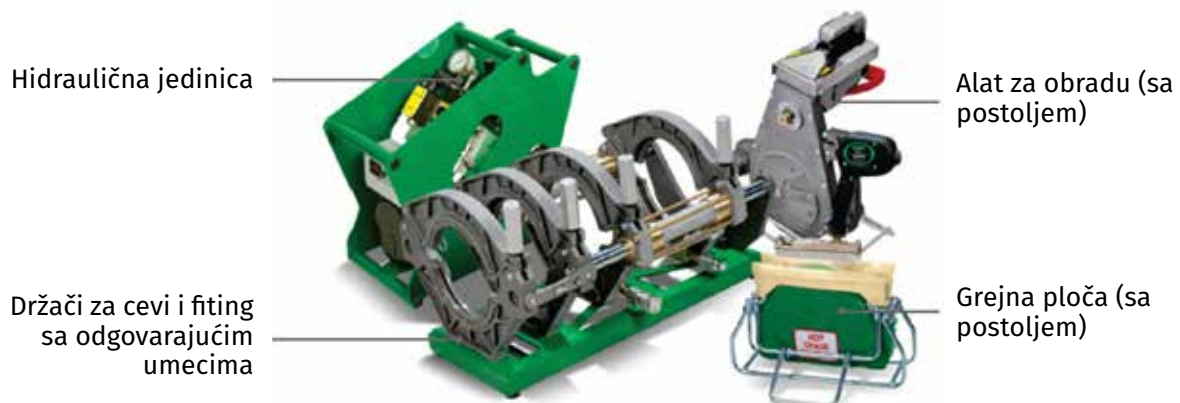
Slika br. 40: Izgled hidraulične mašine za čeono varenje
