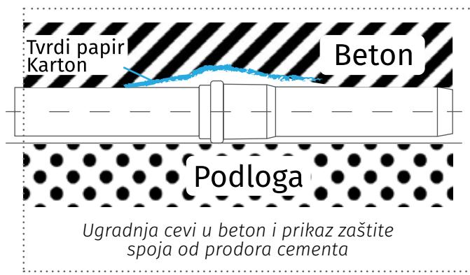
Slika 26: Ugradnja cevi u beton
