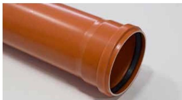
3. Nakon čišćenja i provere stanja zaptivnih elemenata, potrebno je podmazati ravan kraj cevi. Preporučuje se upotreba za ovu svrhu namenjenih Peštan lubrikanata. Ne smeju se koristiti lubrikanti na bazi nafte. Muf i zaptivna gumica moraju biti suvi i čisti. Oni takođe treba da budu namazani lubrikantom.
