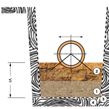
**Slika 16:** Primer polaganja na slabo nosivom tlu debljine  $> 10$  m
