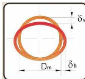
**Slika 28:** Eliptičan oblik deformacije okrugle kanalizacione cevi
