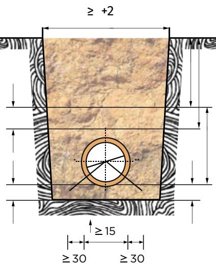
**Slika 15:** Primer polaganja na slabo nosivom tlu debljine  $\leq 10$  m
