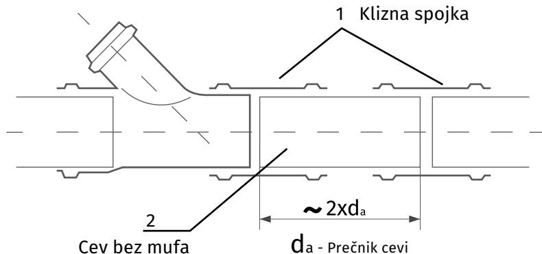
*Slika 20: Spajanje cevi bez mufa kliznom spojnicom*
