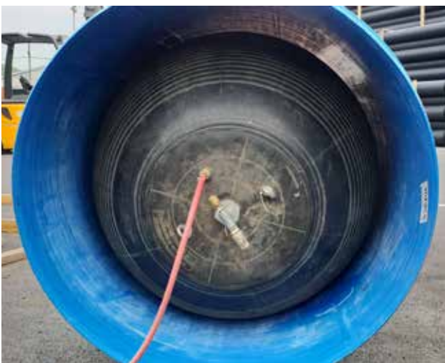
Baloni za ispitivanje nepropusnosti SPIROPIPE cevi
