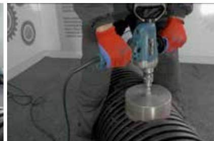
4. Bušenje rupe krunastom testerom
