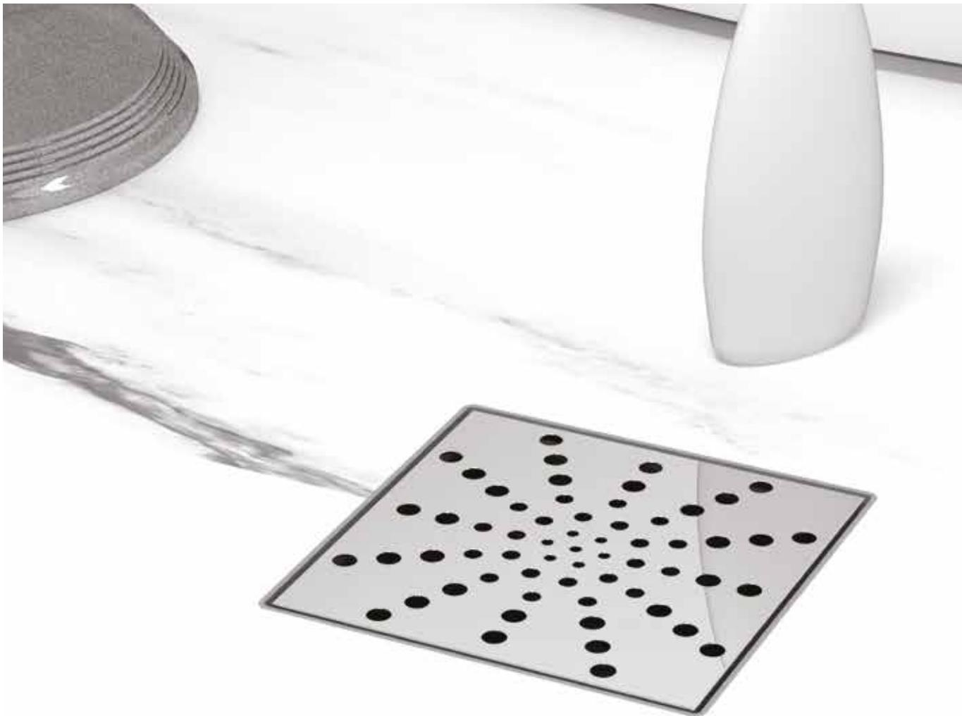
Kockasti slivnici od polipropilena se proizvode sa 4 tipa izlaza i nerđajućom rešetkom napravljenom od AISI 304, dimenzija 150 x 150 mm i 4 različita tipa izlaza i ispoliranom nerđajućom rešetkom npravljrenom od AISI 304. Primo kockasti slivnik od plastike se proizvodi sa rešetkom dimenzija 150 x 150 mm i 200 x 200 mm od polipropilena i 5 različitih izlaza.
