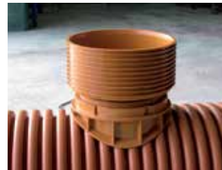
Sedlasti priključak koji odgovara vertikalni (Ø400, Ø500, Ø600) Sa odgovarajućim priključkom (Ø160 i Ø200) za glatku ili korugovanu cev.
