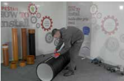
2. Odrješivanje pozicije za montažu
