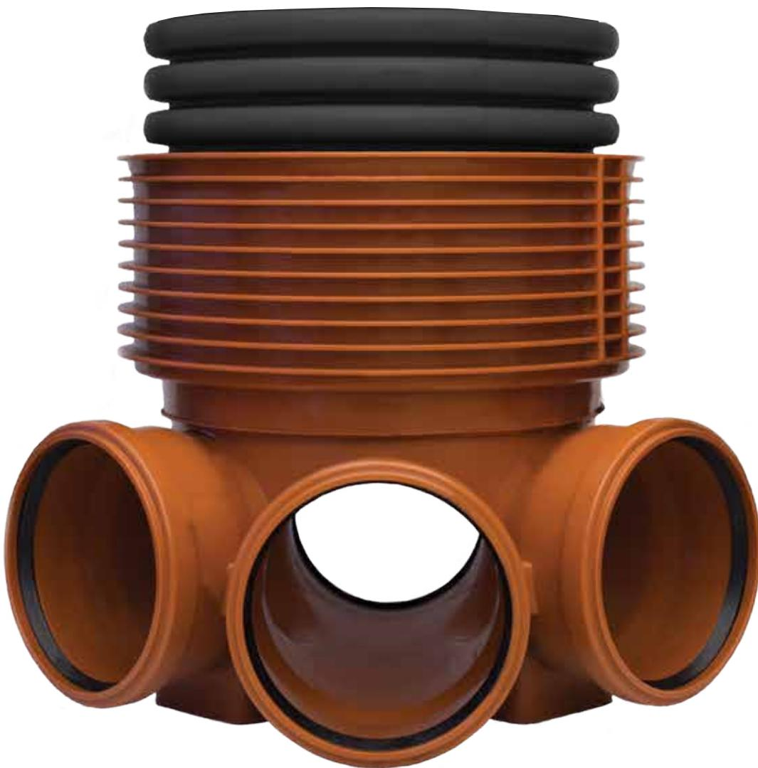
Šahte sa kinetom na dnu, proizvode se od polipropilena - PP (dno šahte). Telo šahte i teleskopski nastavak mogu biti izrađeni od PVC cevi i međusobno su spojeni gumicom za teleskopski nastavak koji obezbeđuje potpunu vodonepropusnost, ili od PP korugovanih cevi. Poklopac šahte izrađen je od kompozitnih materijala u klasi A 150.
