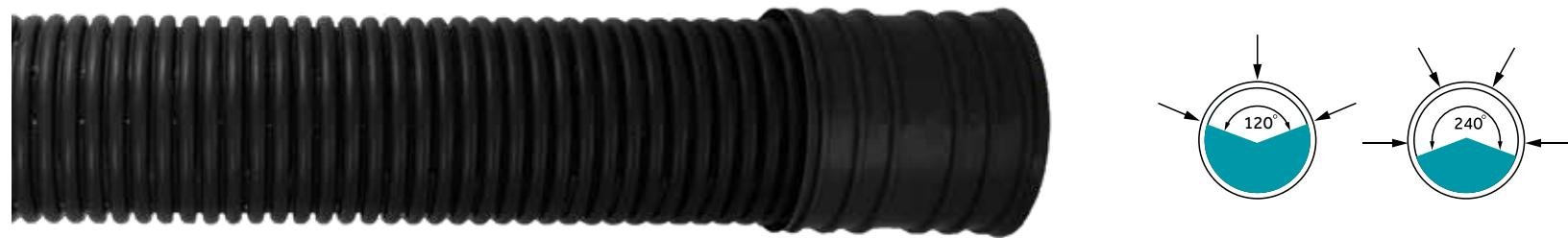
Prozračni kanali na oba tipa cevi se nalaze između rebara cevi, simetrično po obimu celom dužinom cevi što omogućava neometan pristup vode do prozračnog kanala. Prilikom izgradnje drenažnih cevovoda preporučujemo da se cev osim u kameni filterski sloj postavi u dodatni zaštitni filterski sloj od geotekstila radi sprečavanja ispiranja tla i eventualnog blokiranja otvora na cevi nečistoćama i samim tim i smanjenja efikasnosti cevovoda.
