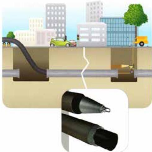
Umetanje manjeg prečnika PE cevi, slip-lining, u postojeći cevovod, je jedna od mnogih tehnika bez iskopa za rehabilitaciju-sanaciju starih cevovoda.
