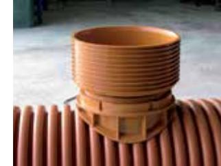
Sedlasti priključak koji odgovara vertikali ( $\varnothing 400$ ,  $\varnothing 500$ ,  $\varnothing 600$ ) Sa odgovarajućim priključkom ( $\varnothing 160$  i  $\varnothing 200$ ) za glatku ili korugovanu cev.
