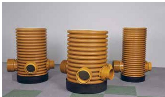
Ukoliko se radi o slivnickoj (revizionoj) sahti Ø500 ili Ø 600 nakon postavljanja priključaka šahta se postavlja u rov, podešava se visina otsecanjem viška cevi (ukoliko je to potrebno prema situaciji na terenu) i postavlja se standardni poklopac bilo betonski bilo liveni s tim da opterećenje koje poklopac nosi ne sme da se prenosi na vertikalnu šahte već ga nosi okolno tlo.
