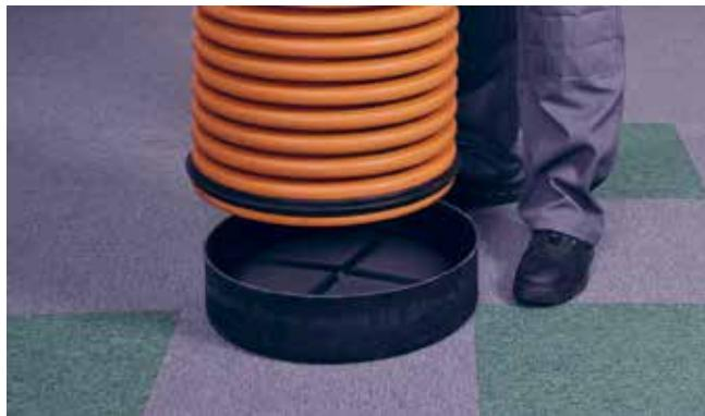
U dno slivničke šahte odgovarajućeg prečnika utisnuti cev sa dihtung gumicom. Dihitung guma mora biti nameštena iz prvog rebra cevi a ne iza drugog kao kada se spajaju cevi sa standardnim muform.
