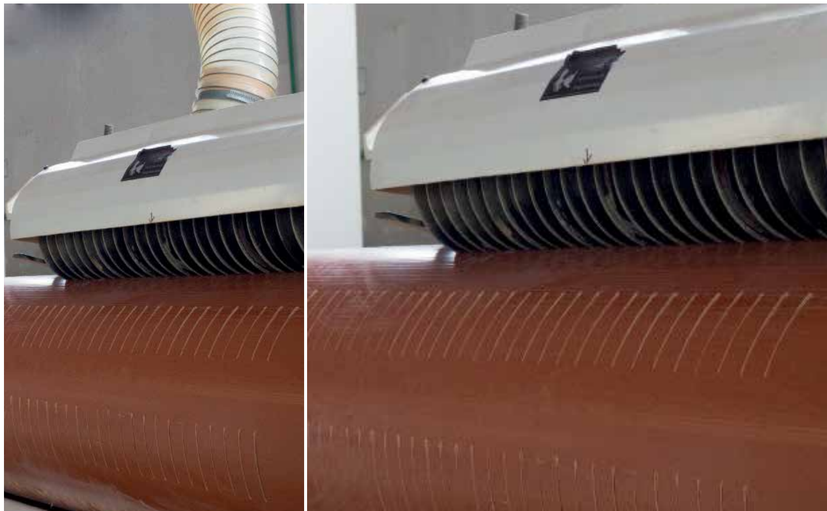
Način izrade perforacija na PVC cevima
